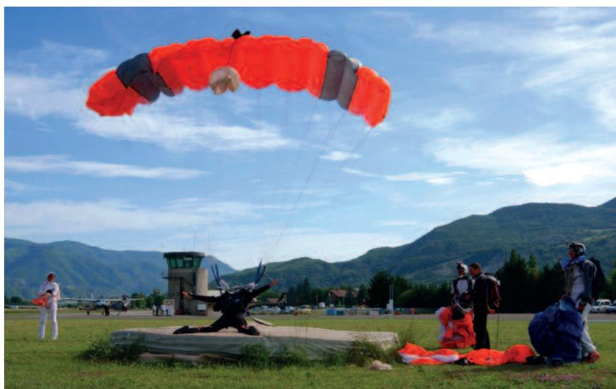
**Le poids, c'est le moteur de la voile.** Plus on charge une aile, plus la vitesse sur trajectoire augmente. L'angle d'assiette, par contre, reste le même.
