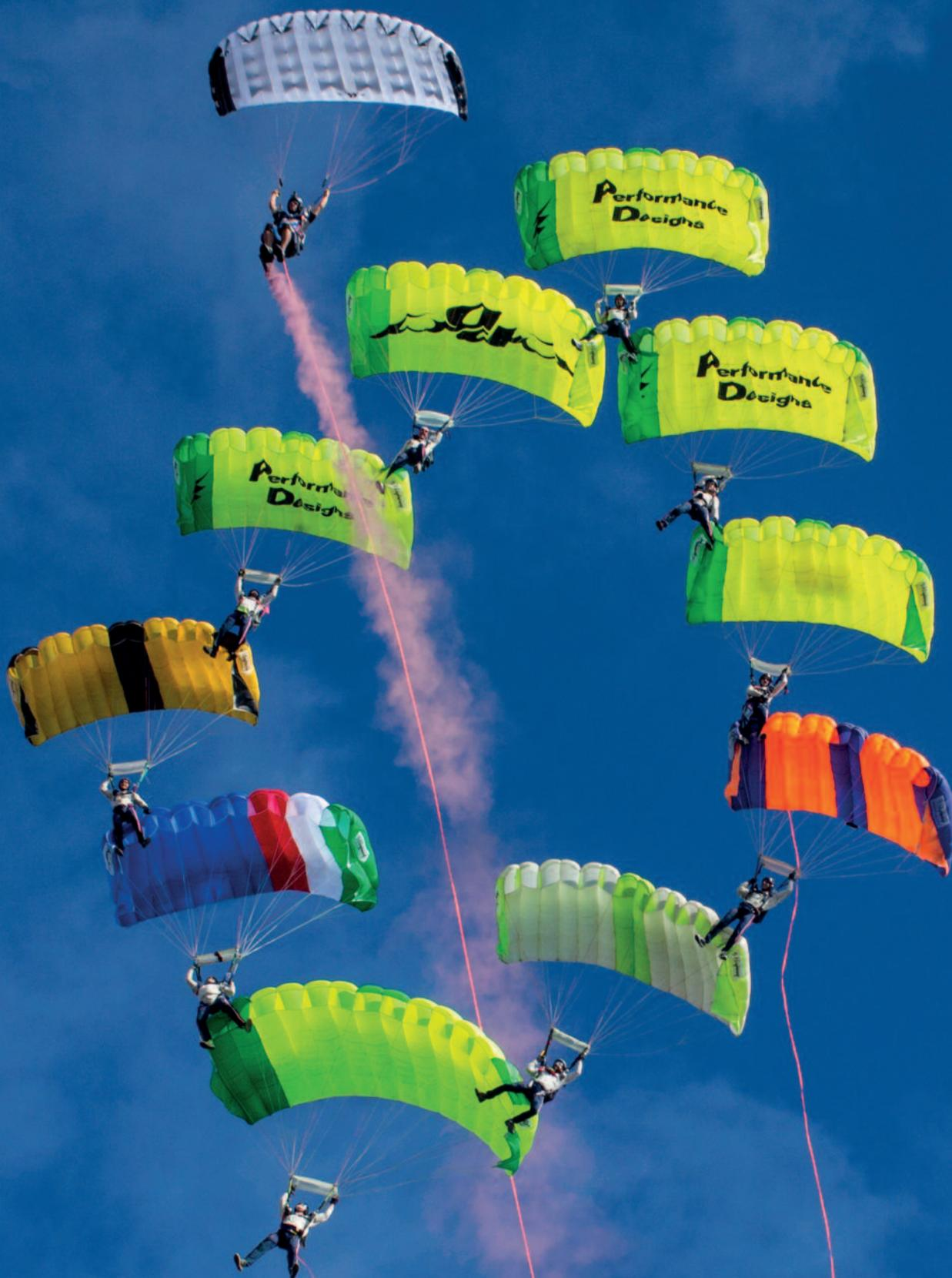
Cette magnifique photo réalisée durant le Project Orange de PD (voir brève dans cette édition) met en scène des voiles de classes différentes (2 à 6), de formes différentes (caissons standards ouverts et caissons croisés tri-cellulaires) volant de concert dans une action originale et engagée : le passage d'une voile haute performance Peregrine (Performance Designs) dans une formation en voile contact nommée "diamant creux", pas vraiment réputée pour sa stabilité...
